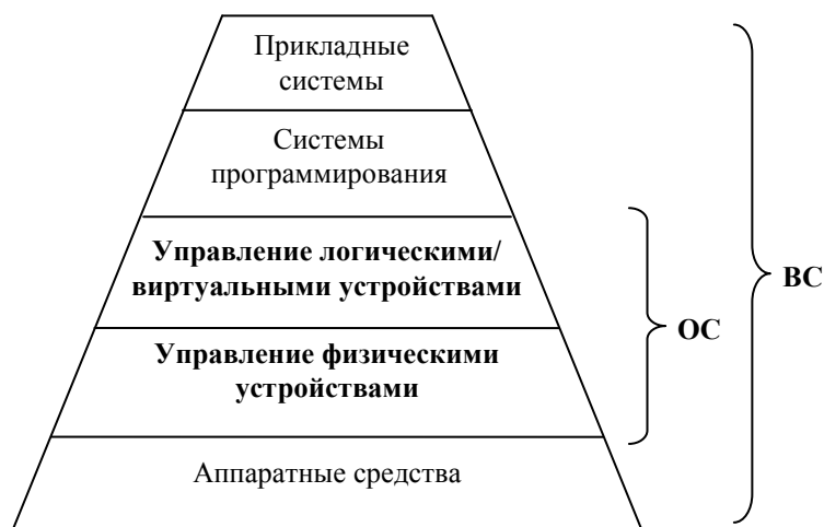
Рис. 4. Структура вычислительной системы.
