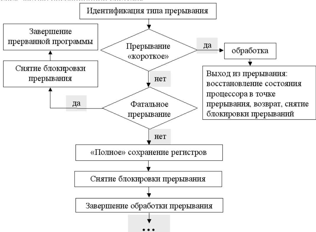
Рис. 33. Программный этап обработки прерываний.
